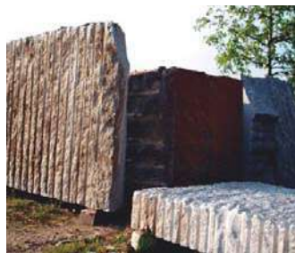
Blocs découpés au perforateur
