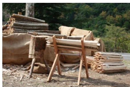
Fabrication de piquets de châtaignier à Boisset © D. BERNARD, PNRHL
